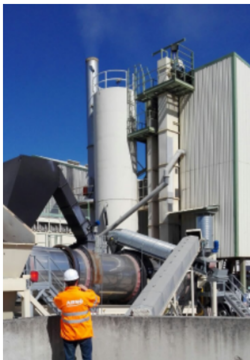
Figura 4: Conducto para extracción adicional de aire caliente del tambor secador en una central discontinua
